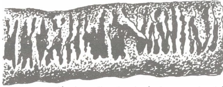
Corrosión de un filtro de tubería de acero al carbón ranurada
